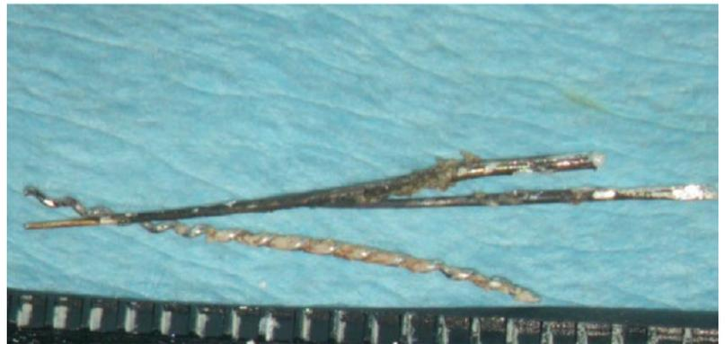
**Abb. 3b** Beide Silberstifte zeigen ausgeprägte Korrosionen.
